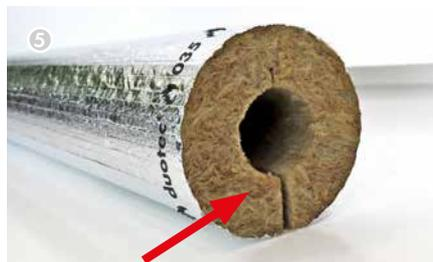
Zur Minimierung des Wärmeverlustes bei waagrechter Montage die Längsnaht so ausrichten, dass sich diese unten am Rohr befindet! <sup>1)</sup>
